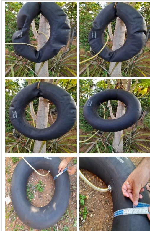
Figura 30 – Ciclos de enchimento da câmara
