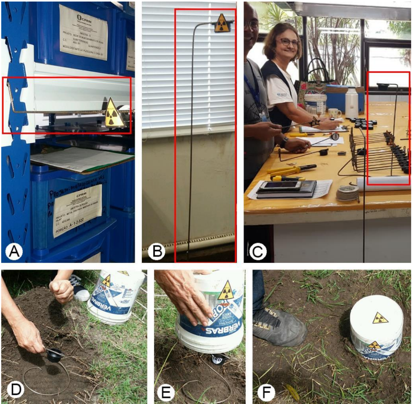
Figura 18 – Detectores instalados com auxílio de suportes metálicos. A) Suporte acoplado à prateleira; B) suporte de piso; C) suporte de mesa (destacados em vermelho); D-F) instalação de detector externo
