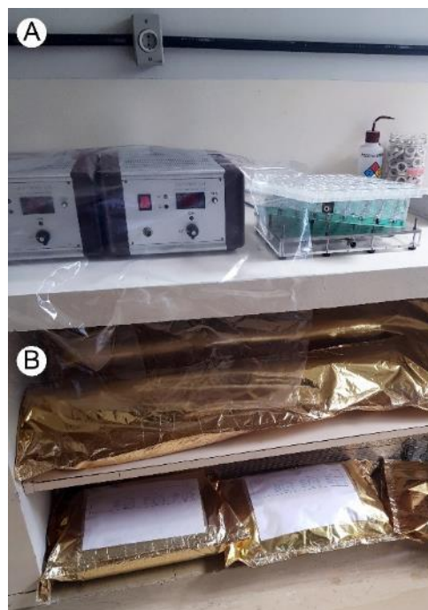
Figura 15 – Laboratório de revelação eletroquímica dos detectores. A) Bancada com as cubas onde as películas recebem o banho em solução condutora; B) embalagem metalizada para transporte dos detectores
