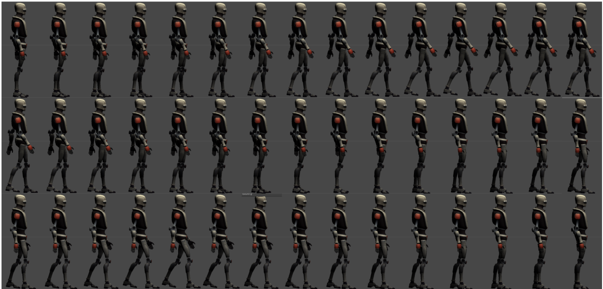
Figura 113 – Frames gerados pela interpolação dos keyframes na Blend Tree .
