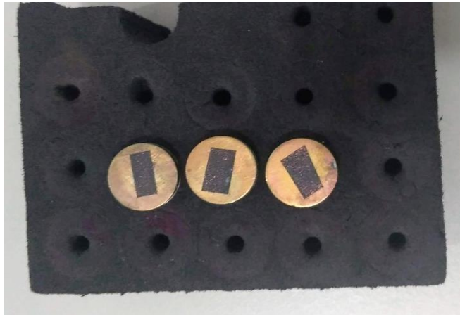
Figura 9. Amostras metalizadas com ouro.
