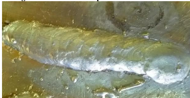
Figura 49. Cordão de no processo MAG com 20 V.
