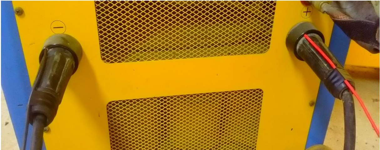
Figura 27. Conexões entre divisor de tensão e fonte.
