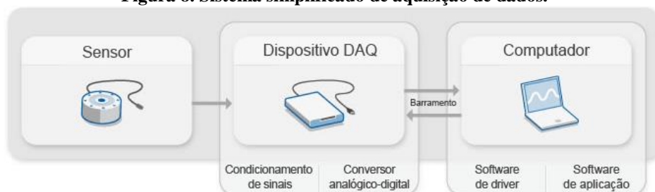
Figura 8. Sistema simplificado de aquisição de dados.
