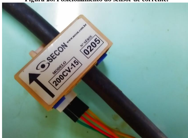
Figura 26. Posicionamento do sensor de corrente.
