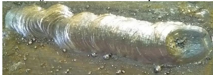
Figura 44. Cordão de solda obtido para 120A.
