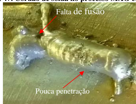
Figura 47. Cordão de solda no processo MAG com 10 V.
