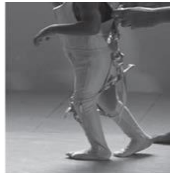
Figura 7. Protótipo 4 com posição das presilhas corrigida, de modo a respeitar a direção das fibras do glúteo máximo.
