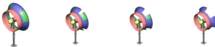
Figura 17 - DAWT com revestimento variado.
