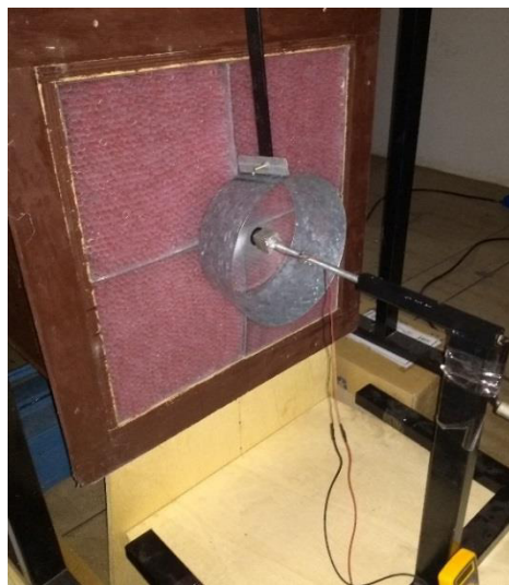
Figura 32- Microgerador eólico com difusor
