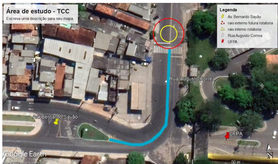
Figura 3 - Proposta de melhoria na Avenida Bernardo Sayão com a divisão das pistas com guard-rail (azul), e a futura rotatória com 4,87m de raio interno (amarelo) e 9,02m de raio externo (vermelho)
