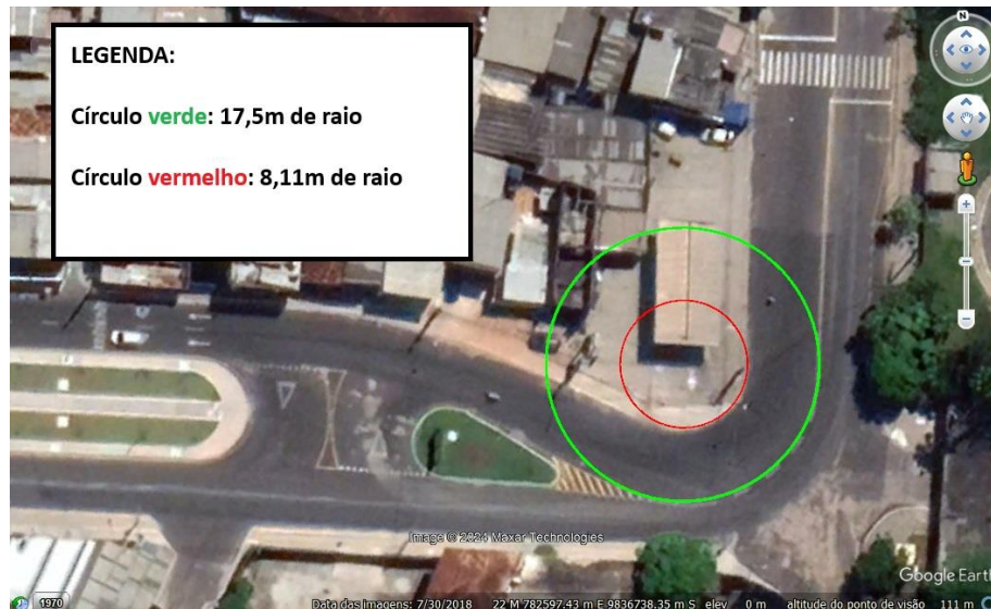
Figura 9 - Raio da curvatura da Rua Augusto Corrêa e Avenida Bernardo Sayão
