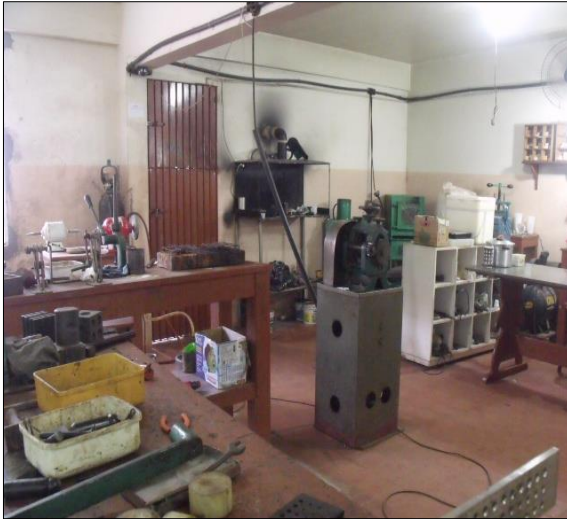
Figura 10 – Fiação elétrica no chão e na horizontal atrapalhando a passagem no interior da empresa.
