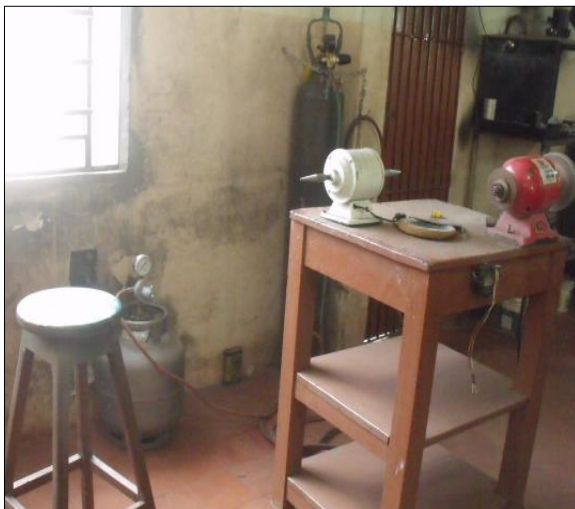
Figura 06 – Presença de poeira, ruído e máquinas mal posicionadas na empresa.
