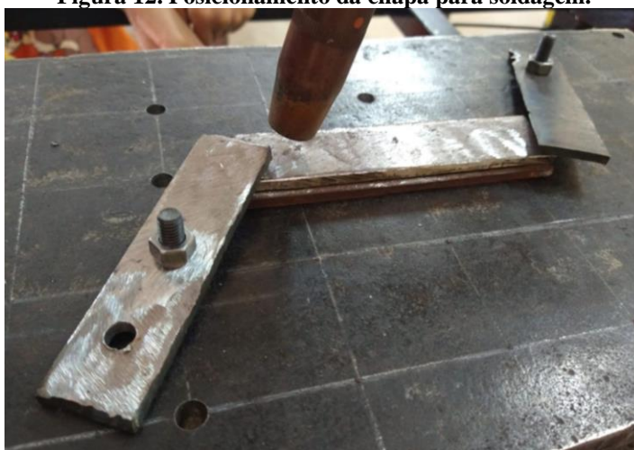
Figura 12. Posicionamento da chapa para soldagem.
