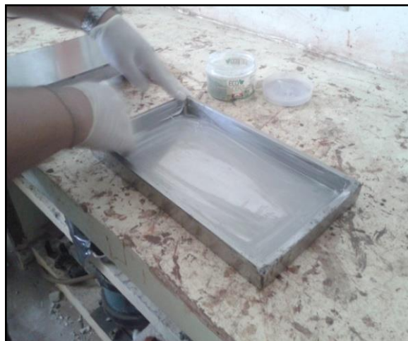
Figura 13. Espalhando o desmoldante (cera). Fonte: (Autoria nossa, 2014).
