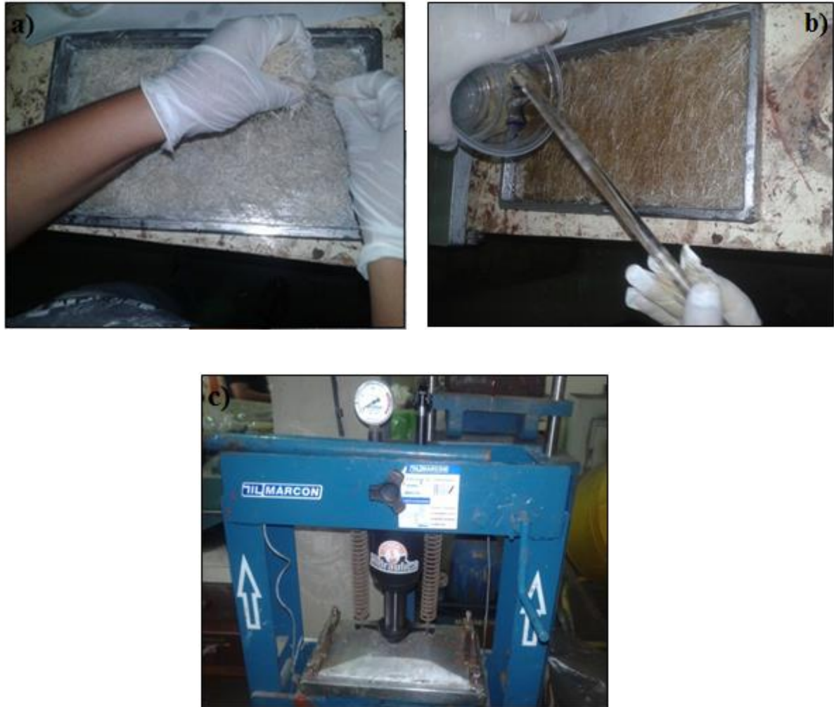
Figura 14. a) Preenchimento aleatório das fibras na placa; b) Adicionando a mistura; c) Placa metálica fechada recebendo compactação pela prensa hidráulica.
