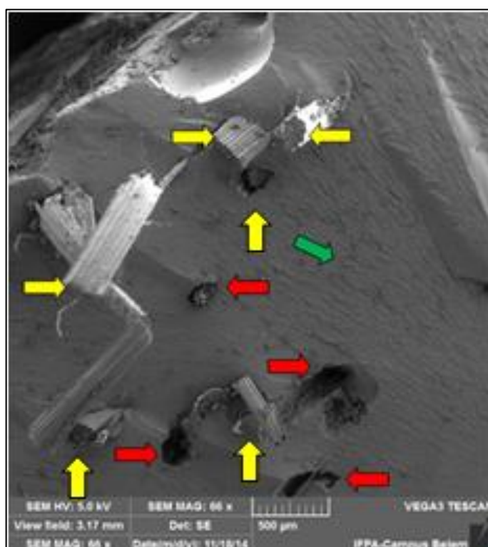
Figura 21. Microscopia eletrônica de varredura da superfície de fratura dos compósitos de matriz poliéster reforçado com fibra da bananeira híbrida PV 0376 da camada mediana.
