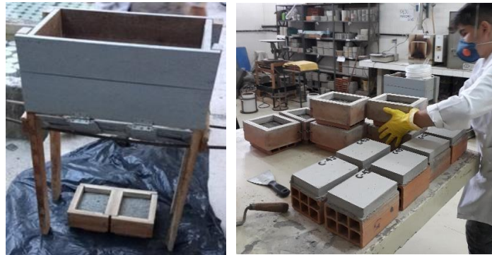
Figura 2 – Dispositivo para lançamento da argamassa sobre os blocos chapiscados e uso de gabaritos para fixar a espessura dos revestimentos em 3,0 cm
