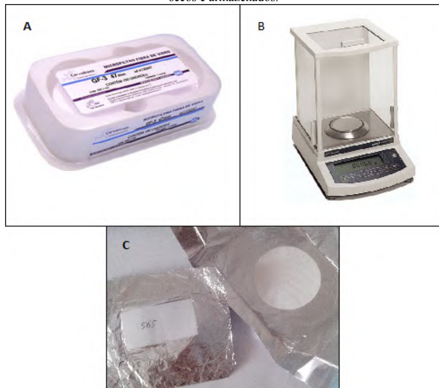
Figura 8 - (A) Microfiltros de fibra de vidro Carvalhaes de 47 mm; (B) Balança analítica; (C) Microfiltros secos e armazenados.
