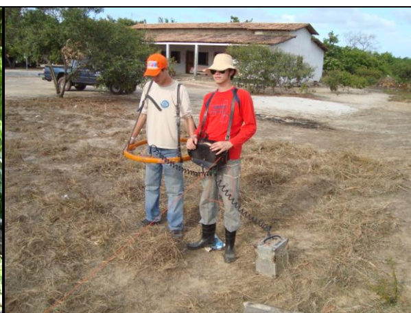
Figura 11: Imagem do equipamento MAX MIN I. a) A bobina receptora (Rx) e b) A bobina transmissora (Tx).
