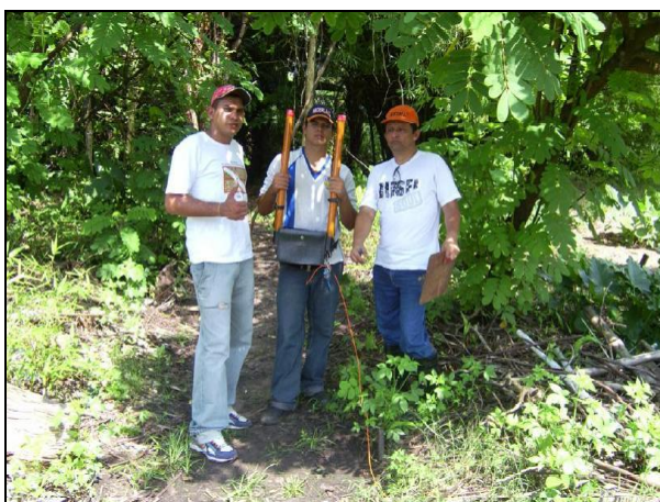
Figura 11: Imagem do equipamento MAX MIN I. a) A bobina receptora (Rx) e b) A bobina transmissora (Tx).
