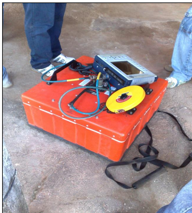
Figura 16: Imagem do equipamento SIR-3000 da GSSI, com antena de 200 MHz.
