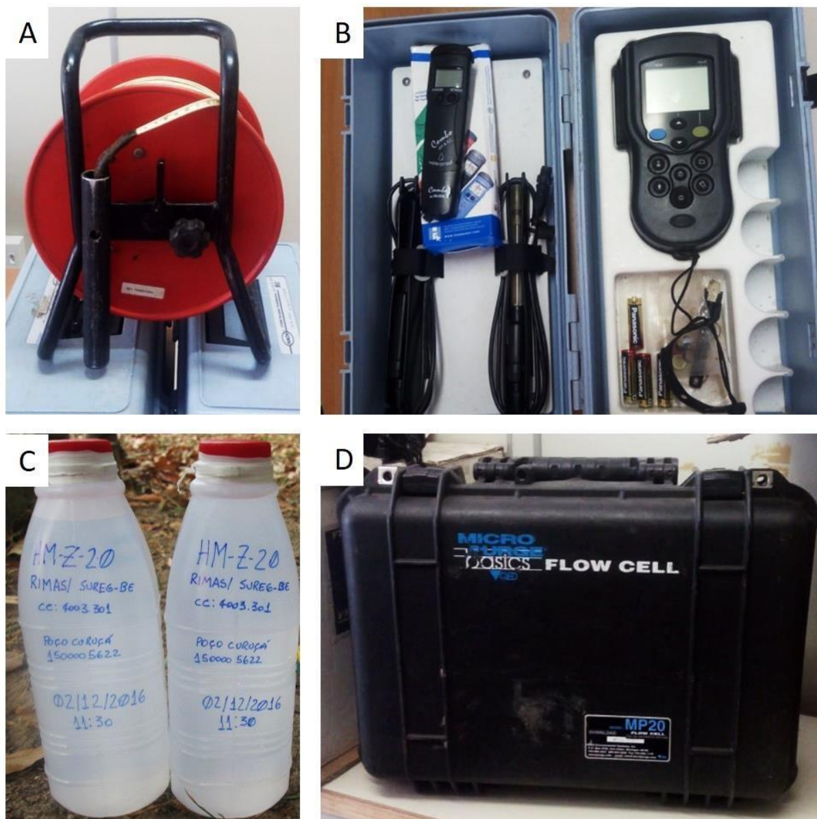
Figura 15 - Instrumentos utilizados na coleta das amostras. A) Medidor de nível de água manual. B) Aparelho HANNA e HACH para efetuar medidas de pH, CE, STD e Temperatura. C) Recipientes (1000ml) de polietileno utilizados no armazenamento das amostras. D) Célula de fluxo responsável por indicar o momento preciso para finalização da purga.
