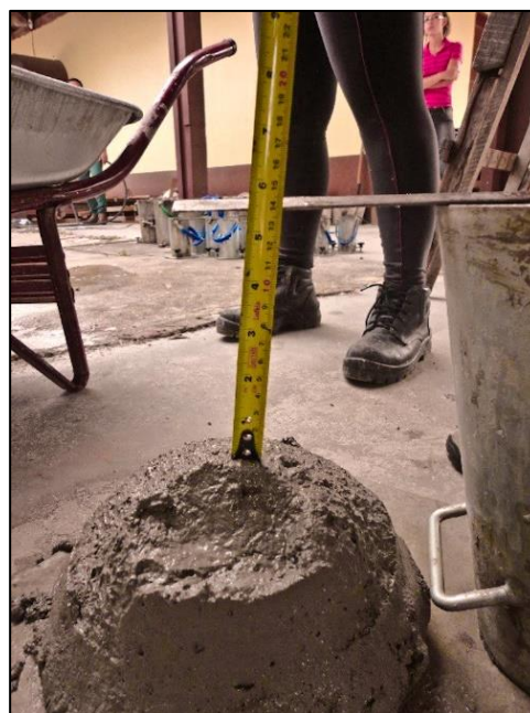
Figura 3.24- Resultado do slump test .
