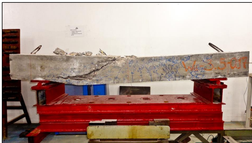
Figura 4.12 -Fissuras W a -3,5-0,17
