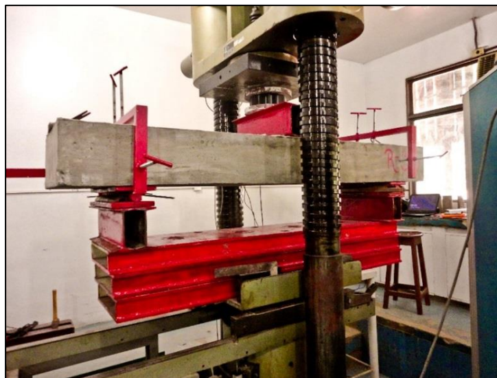
Figura 3.12- Sistema de ensaio real das vigas.
