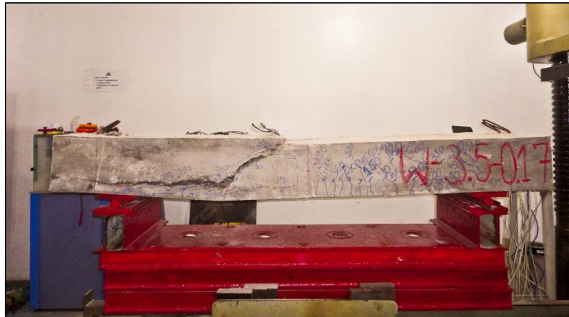
Figura 4.12 -Fissuras W a -3,5-0,17
