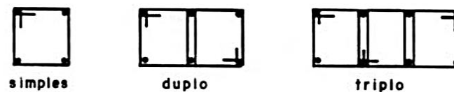
Figura 2.10 -Armadura externa tipo estribo fechado convencional.
