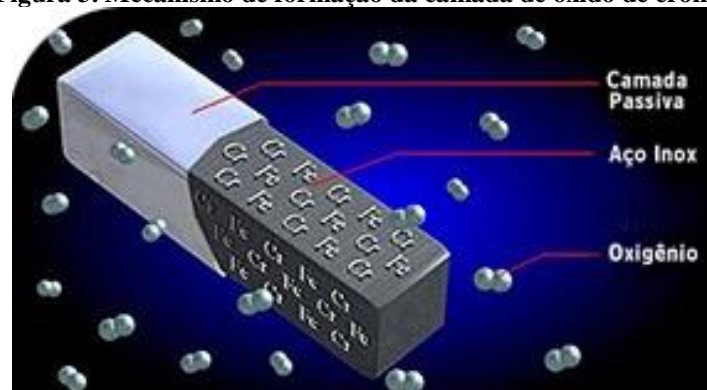
Figura 3. Mecanismo de formação da camada de óxido de cromo.
