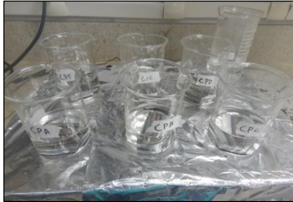
Figura 15. Decapagem dos CP de acordo com a norma ASTM A923.
