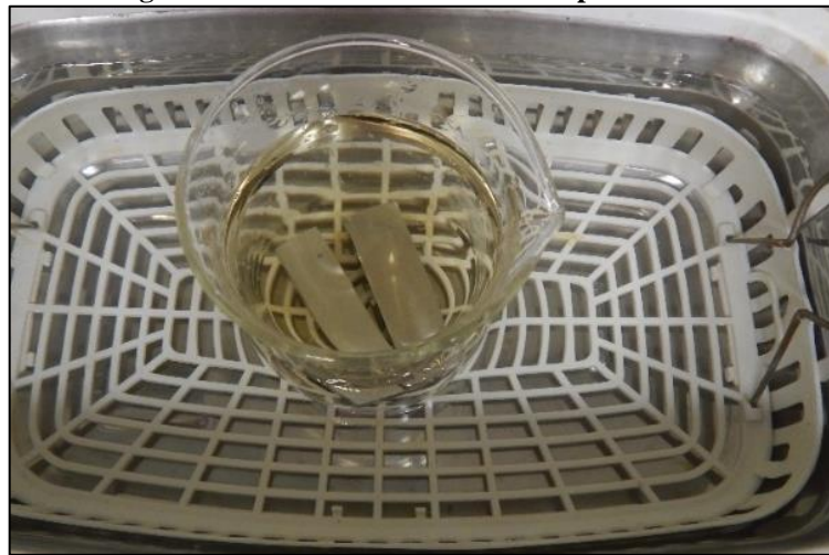
Figura 22. CP na cuba ultrassônica após o ensaio.
