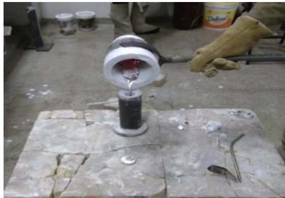
Figura 13 - Metal vazado a 720 °C em molde cilíndrico.
