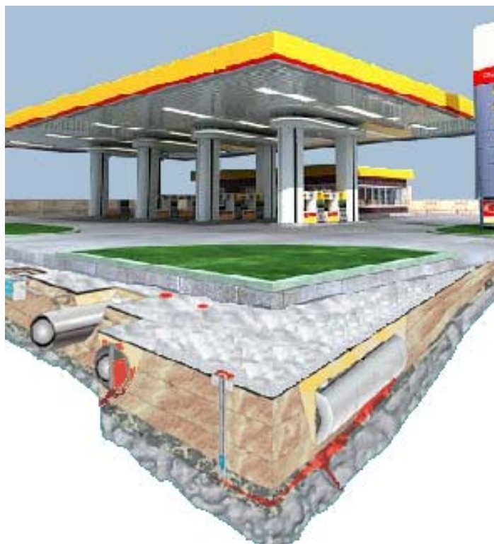
Figura 4 – Ilustração de vazamento de combustíveis em um posto (adaptado de GIIMANN, 2003).
