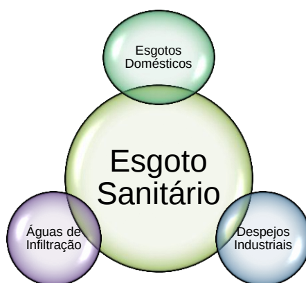
Esquema 1 – Constituição do esgoto sanitário.
