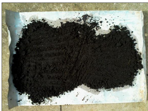
Figura 43 – Ruptura da massa asfáltica.
