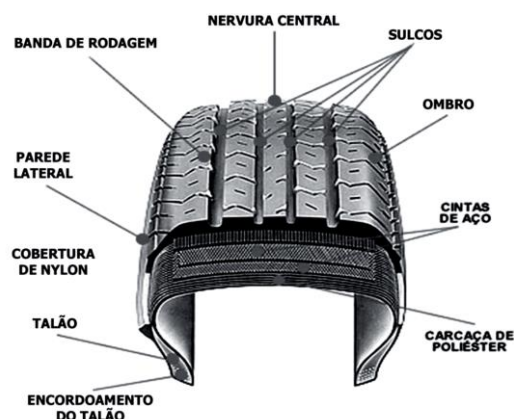
Figura 17 – Estrutura de um pneu de passeio. Fonte: SINDIPNEUS, 2012.
