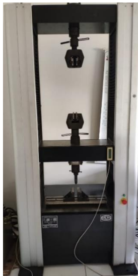
Figura 19 - Equipamento utilizado para o ensaio de flexão.
