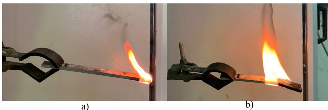
Figura 22 - Propagação da chama durante o ensaio de flamabilidade: a) Início da queima; b) Durante a queima.
