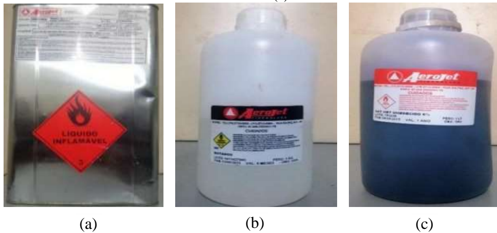
Figura 3.2 - Resina de poliéster insaturado (a), iniciador peróxido de etil-metil cetona (MEK-P) (b) e acelerador de cobalto (c).
