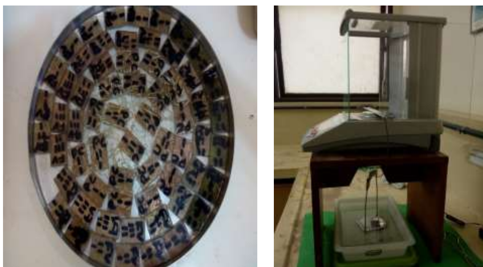
Figura 3.8- (a) Corpos de prova para os ensaios físicos, (b) aparato para pesagem dos corpos de prova.
