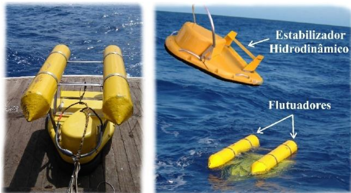
Figura 10: Perfilador de subfundo do tipo chirp modelo SB-512i (X-Star) . Extraído de Gomes (2009).
