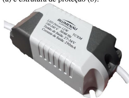
Figura 2.16 - Driver de fábrica do painel LED (a) e estrutura de proteção (b).
