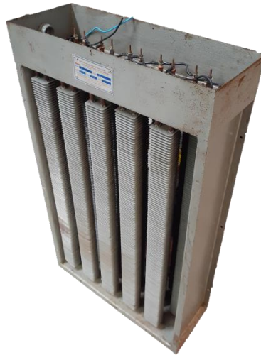
Figura 2.18 - Carga resistiva de alta potência.
