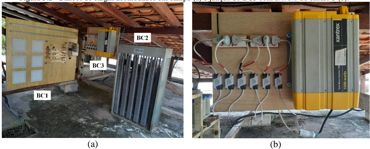
Figura 3.2 - Bancos de cargas acomodados em campo (a) e junção do BC3 com drivers do ensaio 3 (b).
