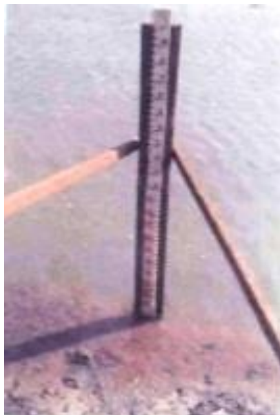
Figura 4 – Medição de altura do rio (régua de madeira).
