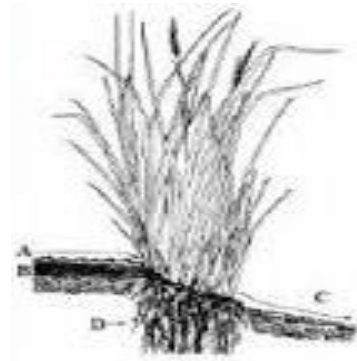
Fig 08 – À esquerda, corte transversal de barreira de capim Vetiver, destacando-se a formação de terraço natural. À direita, desenho esquemático: as folhas e os talos do capim Vetiver retardam o escoamento da água carregada de sedimentos (A), fazendo com que estes se depositem a montante da barreira de vetiver (B), e a água continue a escoar pelo talude (C), a uma velocidade menor. O sistema radicular esponjoso da planta (D) fixa o solo. Fonte: www.vetiver.org .
