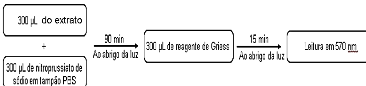
Figura 12- Fluxograma da determinação de atividade antioxidante pelo método de captura de NO
