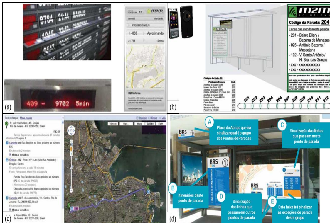
Figura 15 – Tipos de sistema de informações (a) painéis eletrônicos e totens , (b) SMS, (c) Website e (d) placas nas paradas de ônibus.
