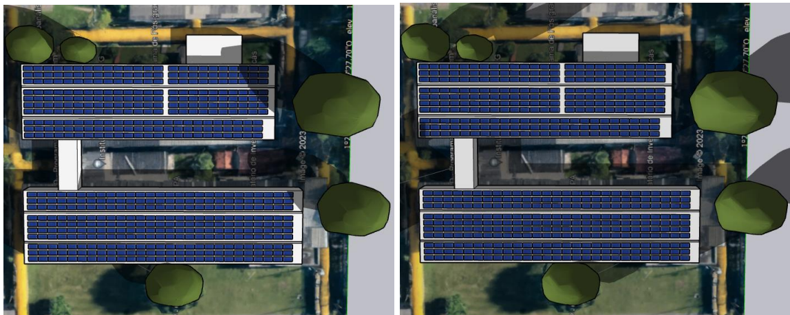
Figura 4. Vista superior do telhado no período de solstício - Dia 22 de dezembro: a) 9 horas e b) 16 horas.
