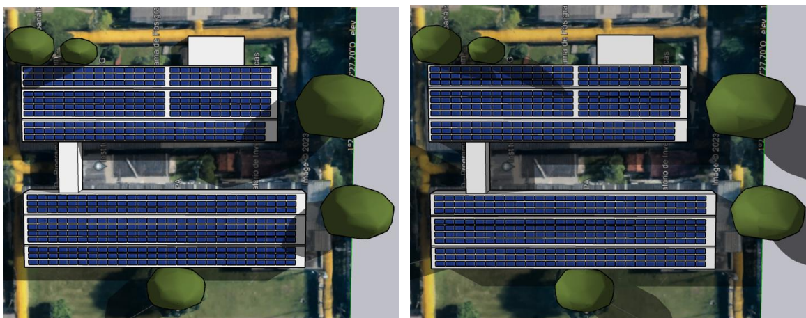
Figura 2. Vista superior do telhado no período de solstício - Dia 22 de junho: a) 9 horas e b) 16 horas.
