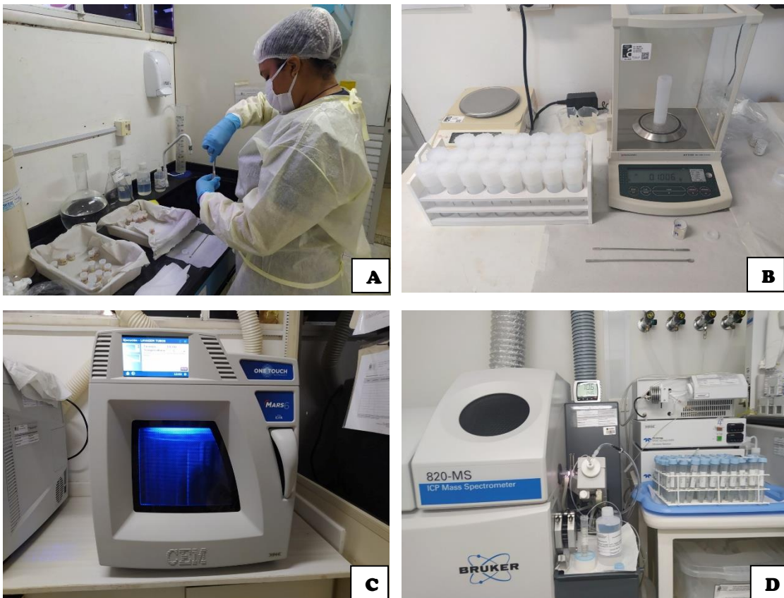
Fig. 3. A. Homogeneização das amostras de tecido de peixes; B. pesagem dos tecidos de peixes; C. digestão de amostras de tecido de peixes em micro ondas; D. Análise das amostras de tecido de peixes em espectrômetro de massas com plasma acoplado por indução (fotos: Thaís Nascimento).
