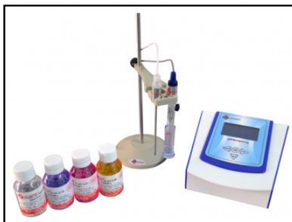
Figura 9 – Equipamento para caracterização do pH.
