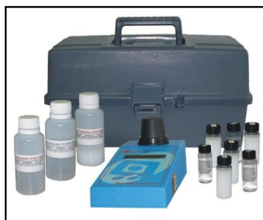
Figura 10 – Equipamento para caracterização da turbidez.
