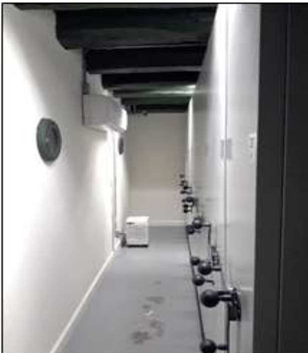
Figura 7 - Estantes de aço deslizantes
