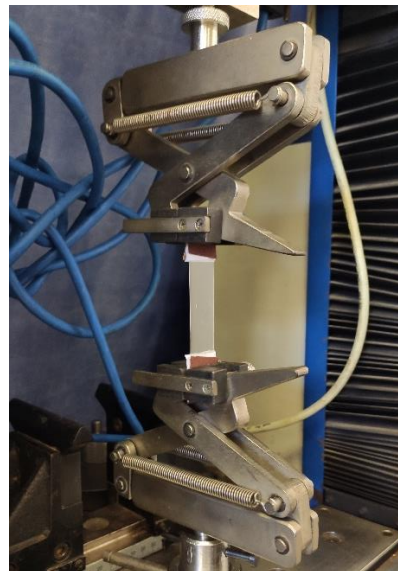
Figura 9: equipamento de testes universais realizando teste de tração.
