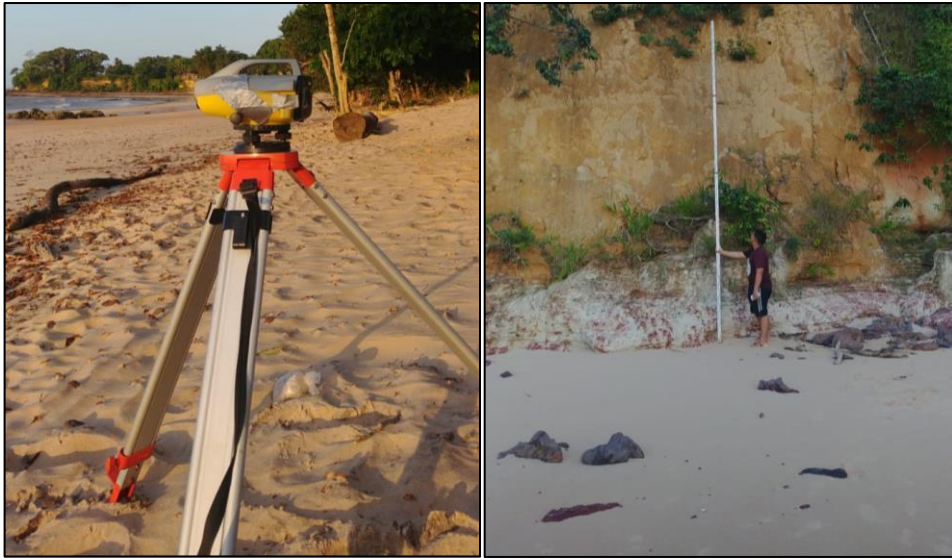
Figura 6- Instrumentos utilizados para aquisição de dados topográficos. Nível ótico + tripé (esquerda). Régua (direita). Fonte: Do autor.
