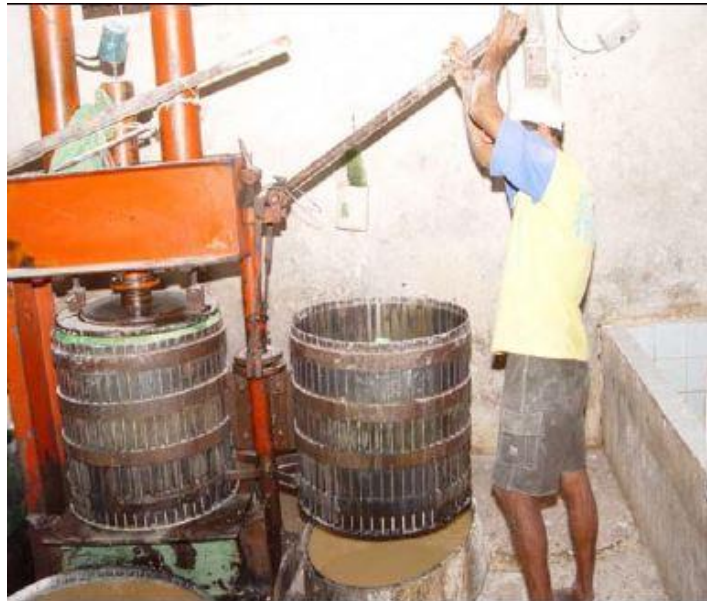
Figura 20: Prensa hidráulica em operação.
