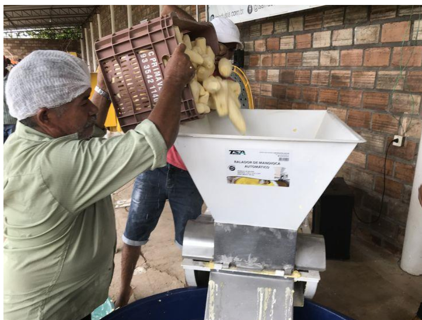
Figura 19: Ralador de mandioca automático em uso.
