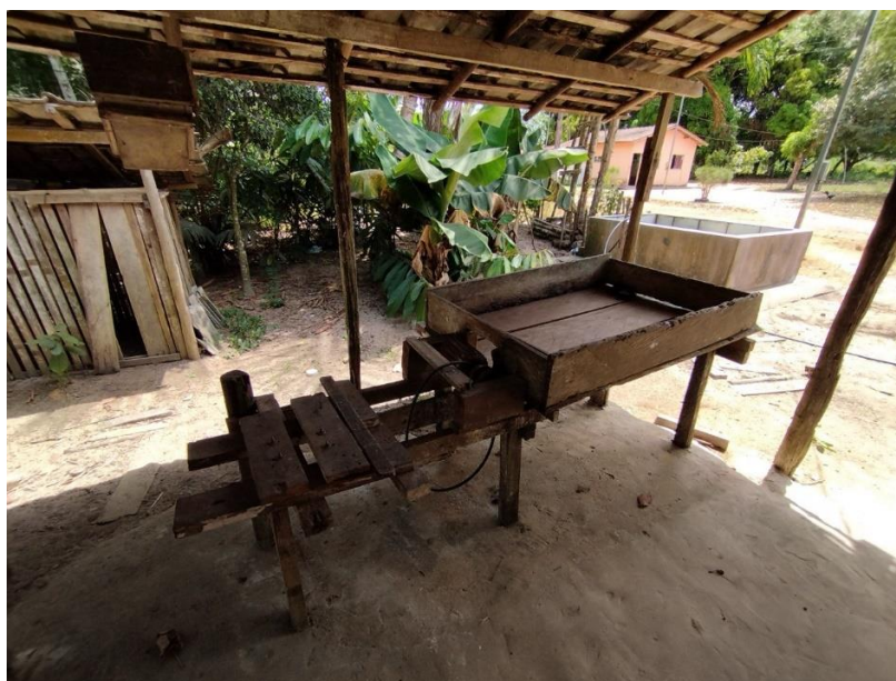
Figura 06: Motor para ralar mandioca
