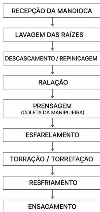
Figura 25: Fluxograma de produção de farinha de mandioca.
