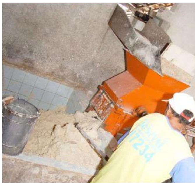
Figura 21: Triturador de raízes em operação.
