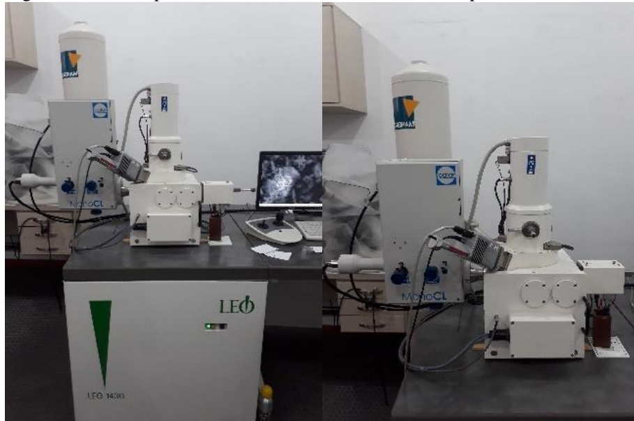
Figura 22 - Imagens do Microscópio Eletrônico de Varredura com EDS acoplado
