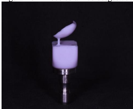
Figura - 6A Bloco cerâmico desgastado
