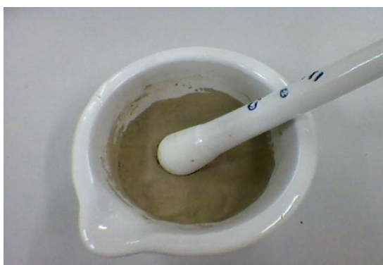
Figura 8 – Desagregação do material.
