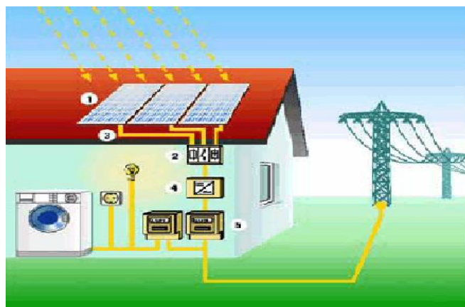
Figura 2. 29 - Sistema conectado à rede elétrica.
