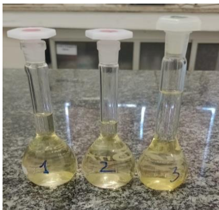
Figura 7- Óleo de açaí degradado solubilizado em Isooctano ( C_8H_{18} )
