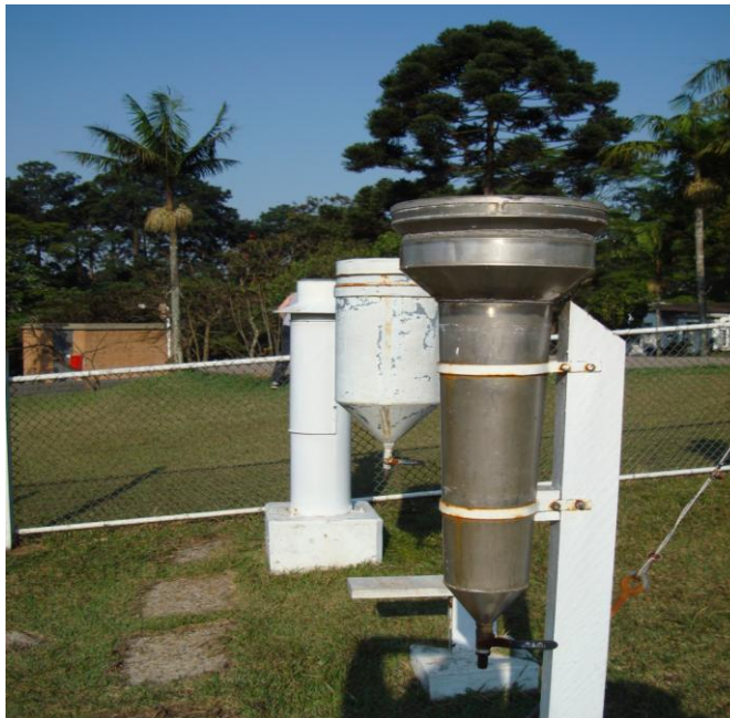
Figura 01 – Pluviômetro da Estação Meteorológica do IAG-USP.
