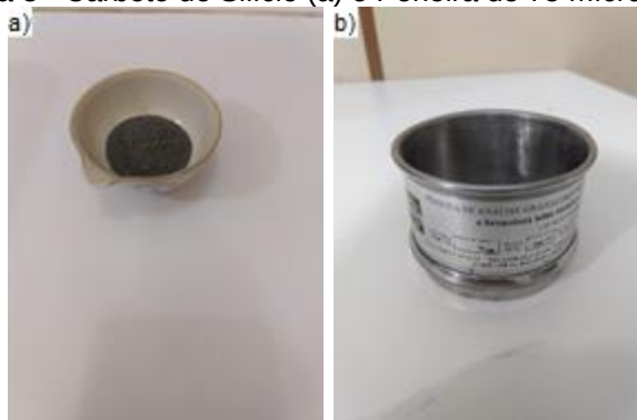
Figura 8 - Carbetto de Silício (a) e Peneira de 75 microns (b).
