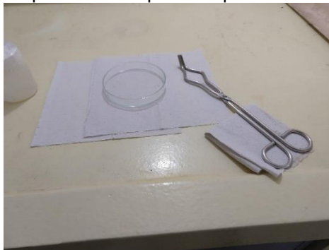
Figura 19 - Material de apoio utilizado para ataque de com ácido fluorídrico 0,5 %.
