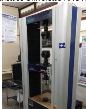
Figura 32 - Máquina de Ensaio Universais AROTEC WDW- 100E, no IFPA.
