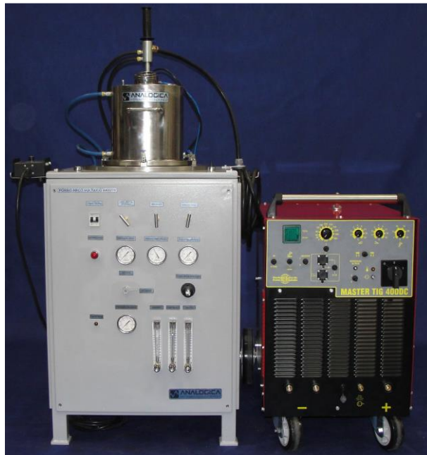
Figura 6: Forno a arco modelo AN9270
