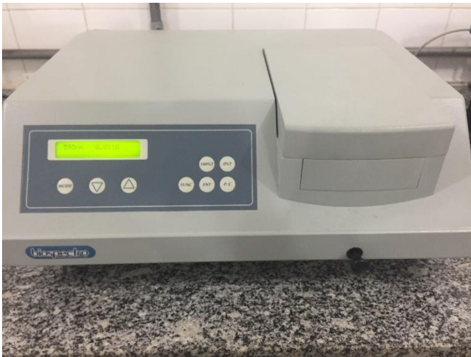
Figura 7- Leitura da absorbância dos extratos no espectrofotômetro.
