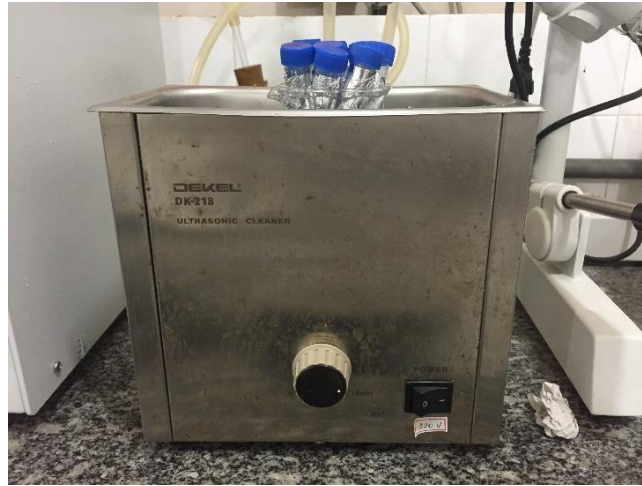
Figura 10- Banho de ultrassom das réplicas para extração de compostos clorofilados.
