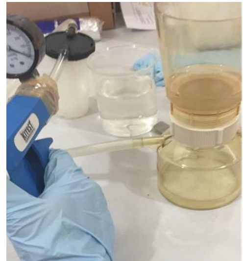
Figura 6- Filtragem de um volume conhecido de amostra de água.
