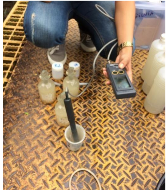
Figura 3- Realização de coleta de parâmetros físico-químicos com auxílio de um analisador multiparâmetros.
