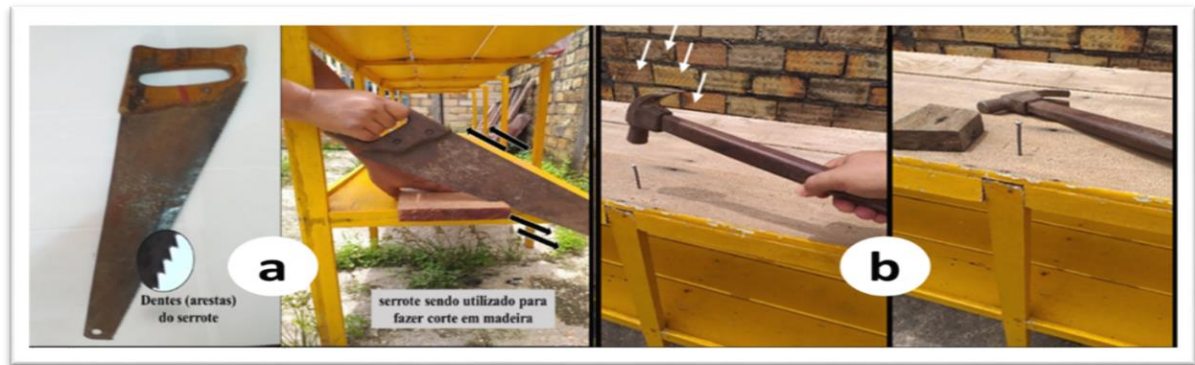
Figura 13: a) aplicação do serrote na construção civil; b) a utilidade do prego e do martelo com inúmeras aplicações da pressão.
