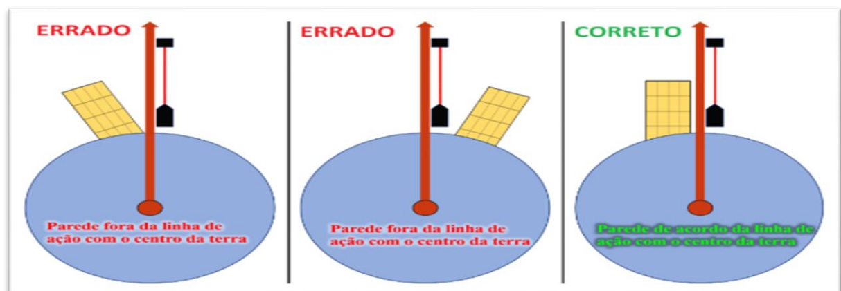
Figura 11: A ação gravitacional e o uso do prumo nas edificações.
