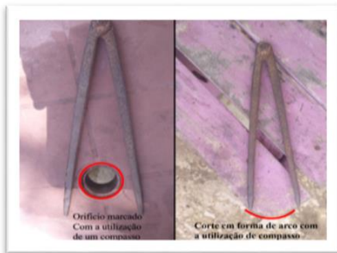
Figura 22: O uso do compasso na realização de furos e corte curvados
