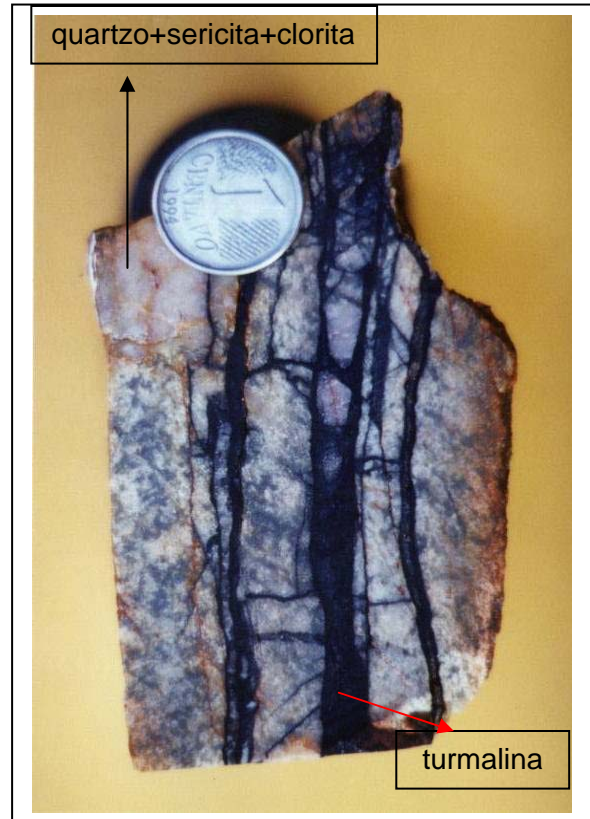
Figura 9. brecha hidrotermal onde o fluido penetrou nos planos de fraqueza da rocha
