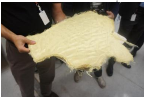
Figura 4 - Fibras de Kevlar costuradas formando a placa balística.
