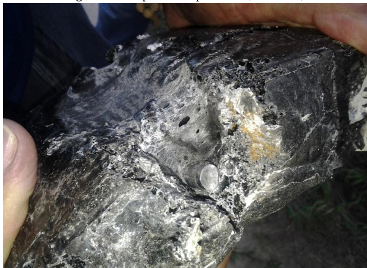
Figura 36 – Impacto não perforante, calibre 0,380”.
