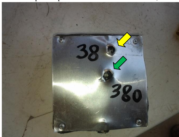
Figura 28 – Impactos perforantes de saída calibres 0,38" e 0,380".
