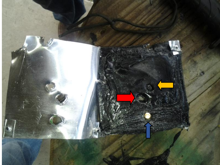
Figura 32—Desmontagem da placa para mostrar o projétil 0,38" oca alojado no compósito.
