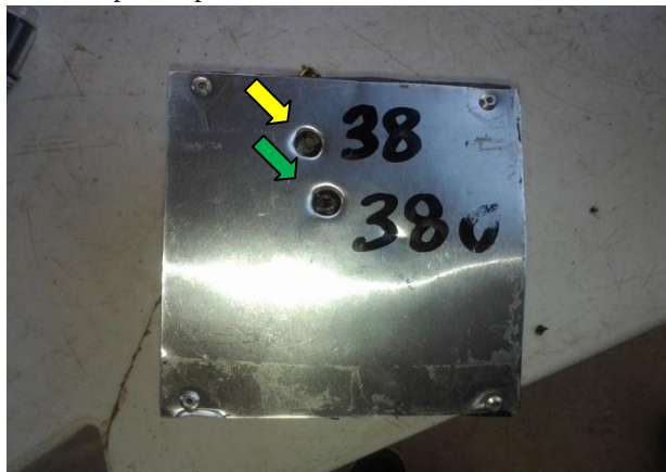
Figura 27 -Impactos perforantes de entrada calibres 0,38" e 0,380".
