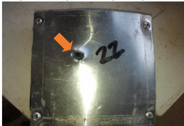
Figura 26 – Impacto de saída perforante em placa simples com calibre 0,22".
