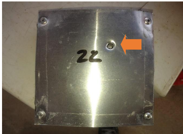
Figura 25 - Impacto de entrada perforante em placa simples com calibre 0,22"
