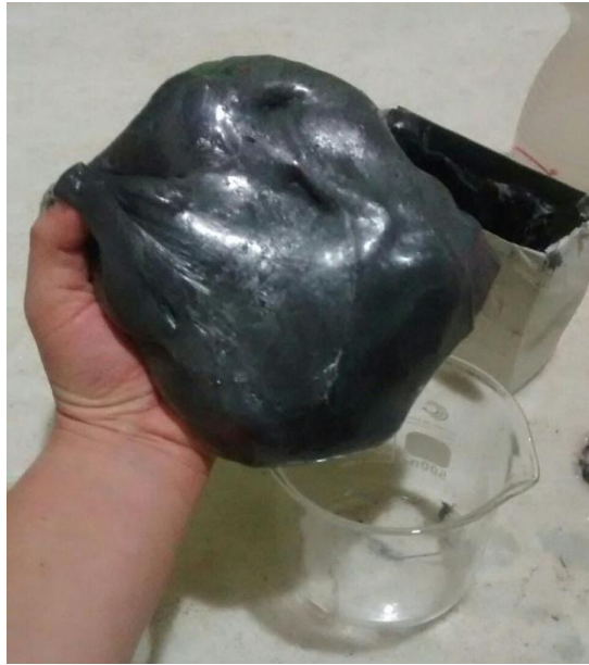
Figura 18 - Material resultante do processamento do EPS com a cinza do açáí.
