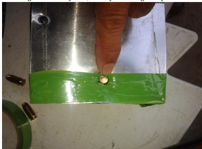
Figura 31 – Projétil 0,38" alojado na segunda placa.
