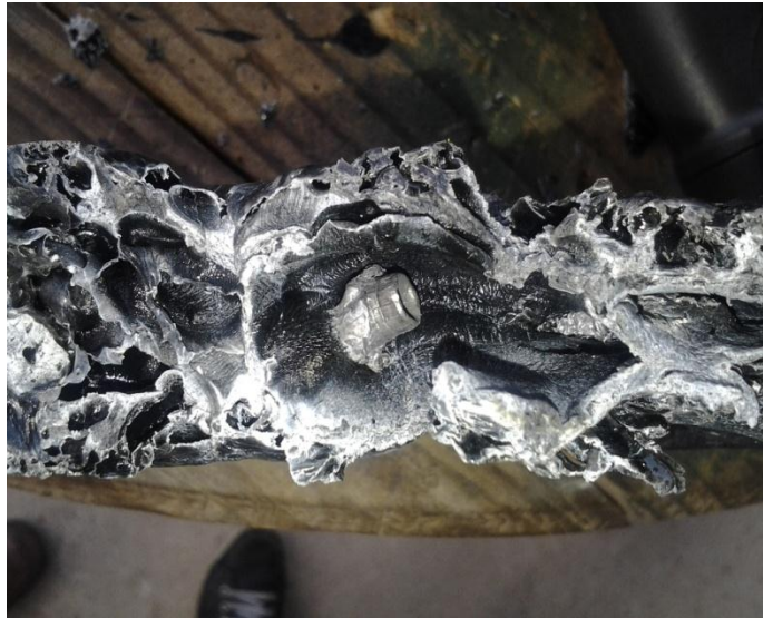
Figura 35 – Detalhe ampliado da zona e deformação do projétil calibre 0,22".
