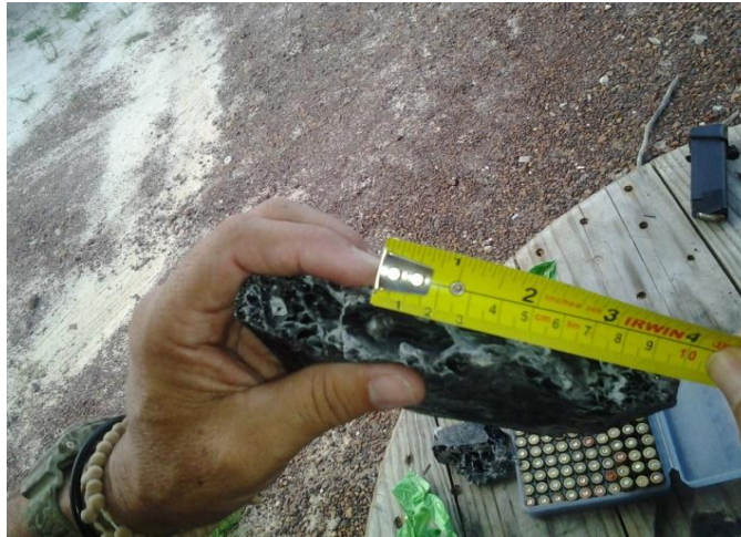
Figura 34 - Penetração do projétil calibre 0,22" entre 10 e 11 cm.
