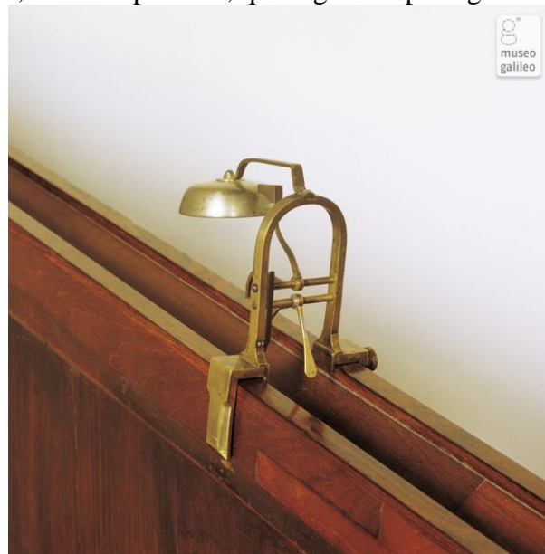
Figura 3. Sino de trilho, com um pêndulo, que registra a passagem da esfera no plano
