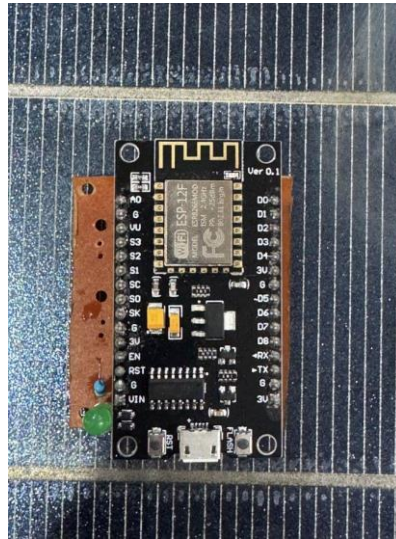
Figura 19 — mostra o NodeMcu conectado na placa.
