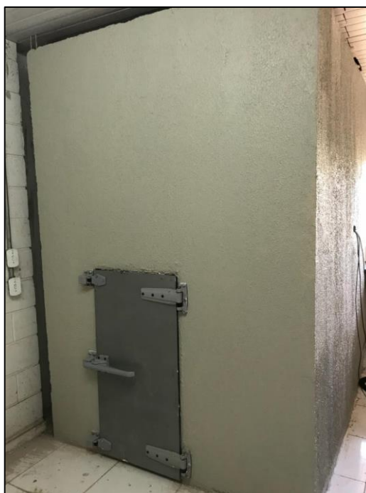
Figura 3. Câmara reverberante em escala reduzida do Laboratório de Acústica do CAMTUC.
