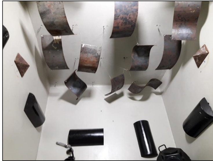
Figura 7. Imagem dos difusores durante os testes realizados.
